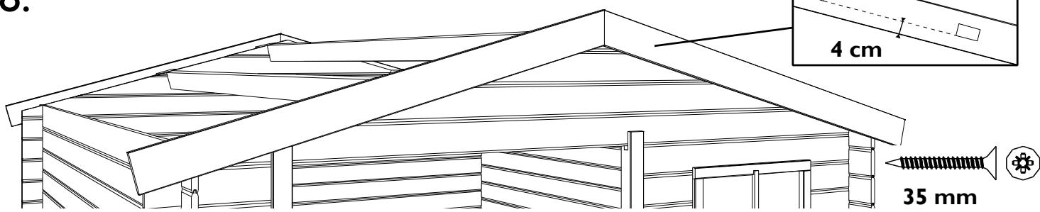
**NL:** Plaats de sierlatten FSL voor- en achteraan. Vijs met schroeven van 35mm op de hulpdakbalkjes en bovenste plank van de zijgevels zodanig dat de onderkant van de sierlat 4cm onder de onderkant van de hulpdakbalkjes zit.
