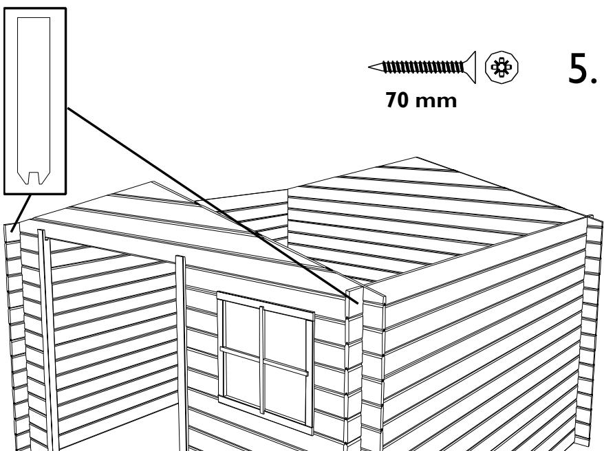
**NL:** Indien er hoogteverschillen zijn tussen de wanden onderling, controleert u of planken goed aansluiten. Om een hoogteverschil op te vangen (detail A) brengt u de bovenste plank gelijk met de puntgevel en vijs deze aan elkaar (detail B). Breng nu dmv kleine tikjes de onderliggende planken 1 voor 1 omhoog (detail C) om zo de spatie te verdelen over alle planken (detail D).
