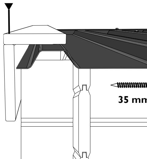
**NL:** Schroef de stormsierlatten OSL boven op de FSL. Zie detail. Breng als afwerking het schildje aan waar de sierlatten FSL samen komen.
