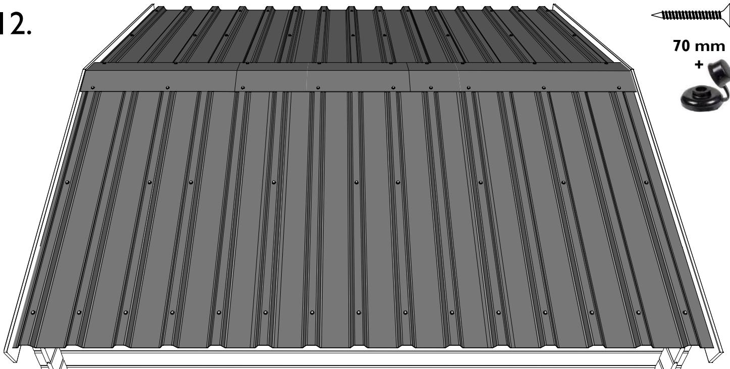
**NL:** Plaats de nokken. Verdeel de verschillende stukken over de lengte van het dak. Hou rekening met de overheersende windrichting: begin weg van de wind en werk in de richting van waar de wind komt.
