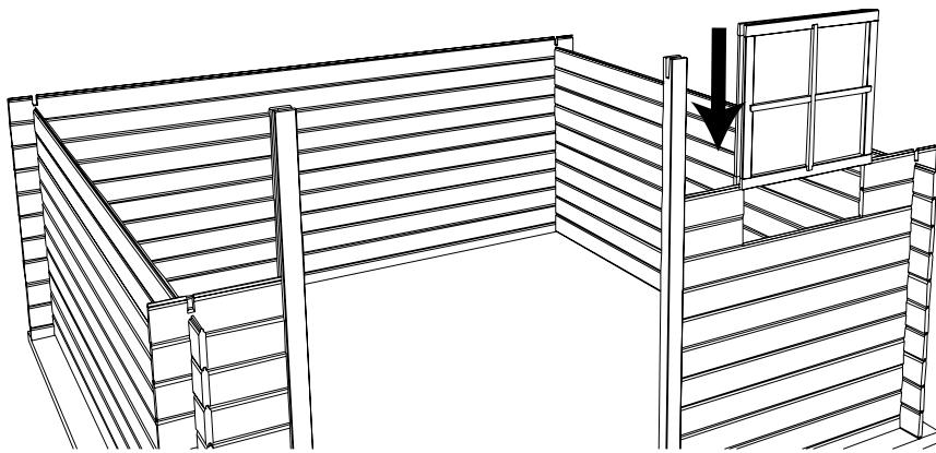
**NL:** Bouw verder op volgens de meegeleverde plannetjes (zie gedetailleerde onderdelenlijst) tot U ter hoogte van de onderkant van het raam komt. Plaats nu nog 2 lagen extra. Indien het model een raam in de zijwand heeft kan U zelf kiezen of U het raam in de linker- of rechterwand plaatst. Laat het raamkozijn in de opening zakken. **Maak uw kader niet vast dmrv schroeven of nagels aan uw beringing!** (“Hout leeft”).
