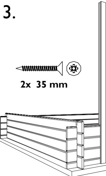
**NL:** Laat de deurstijlen in de opening zakken. **Mak de deurstijlen enkel onderaan aan de blokhut vast met een schroef, bovenaan vijf U nooit aan de blokhut zelf** (zie tips en adviezen 'hout leeft'). Het afwerken van de deur doet U best als de blokhut volledig gemonteerd staat.
